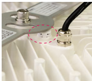
B. 呼吸キャップの落下防止のために最適な設置位置の設計
