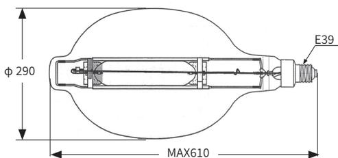
適合安定器 Matching Ballast 匹配镇流器 **KE34P, KD30EP, KD32EP, KD40TP, KD42TP, KT41PHV (50Hz)**
