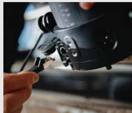
PoE++ 採用により最大 100m まで有線コントロールが可能
